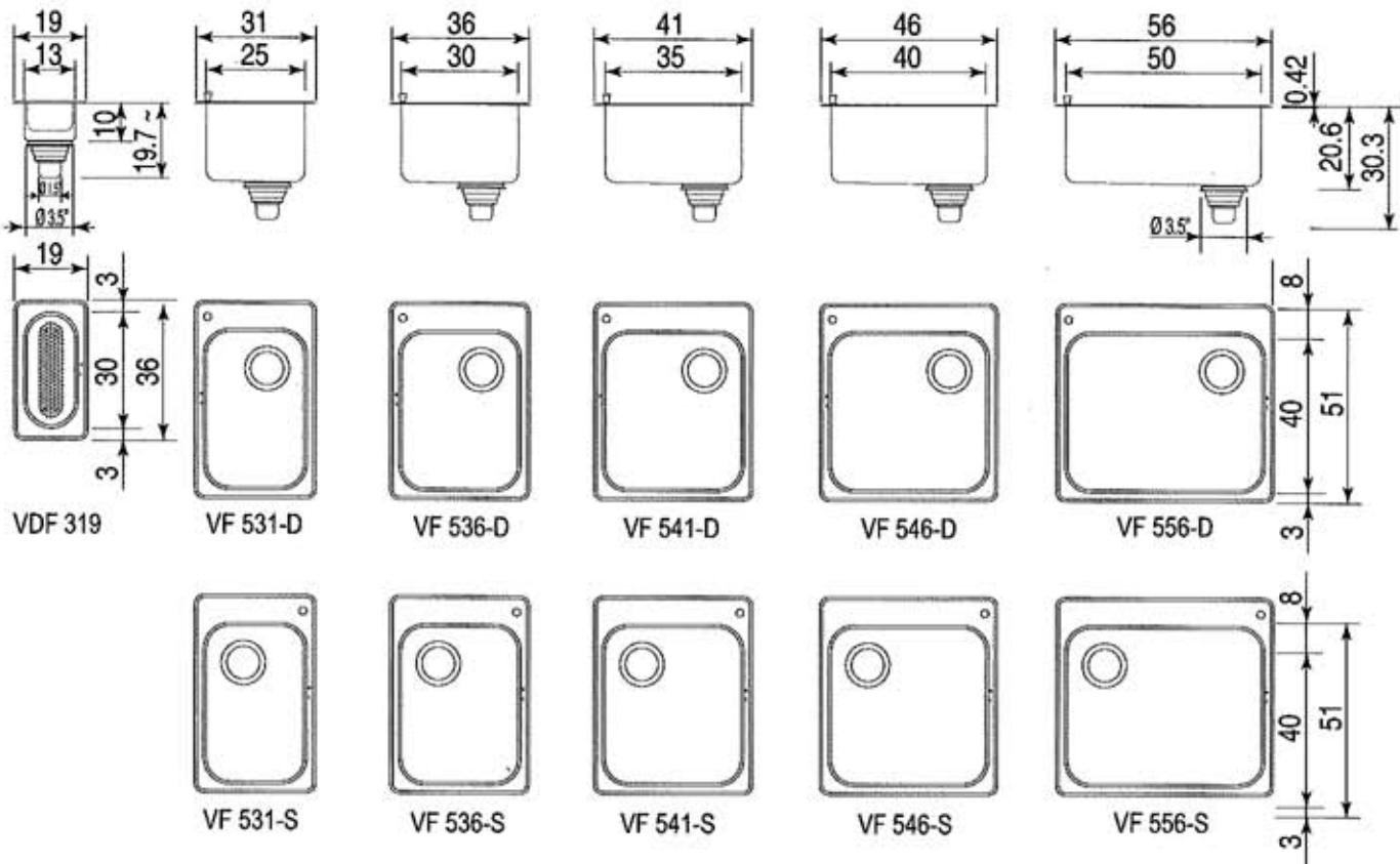
Dimensioni fori incasso vasche - Abmessungen des Becken-Einbauausschnitts
