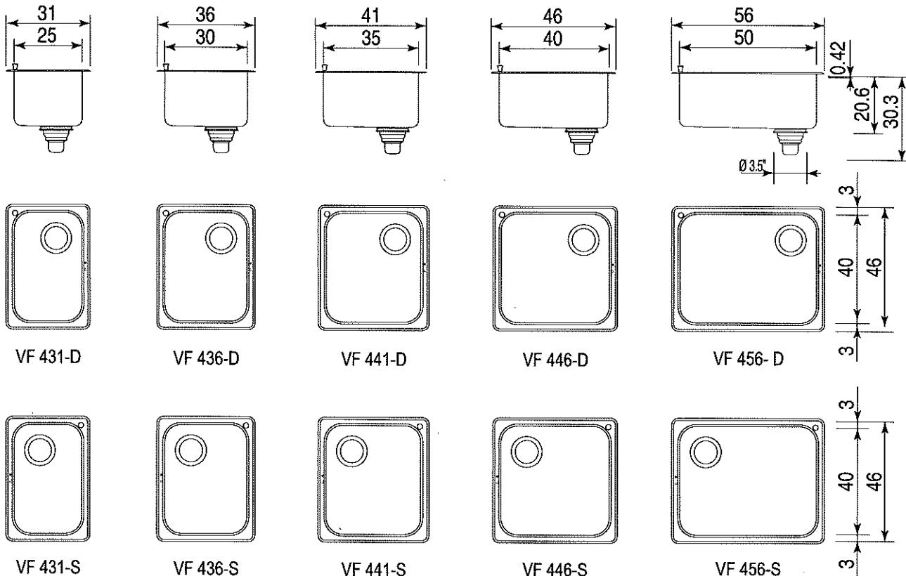
Dimensioni fori incasso vasche - Abmessungen des Becken-Einbauausschnitts
