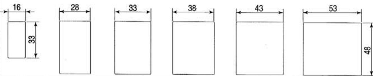
DIMENSIONI E POSIZIONI FORO INCASSO GRUPPO DI EROGAZIONE - ABMESSUNGEN UND POSITION DEN WASSERHAHN
